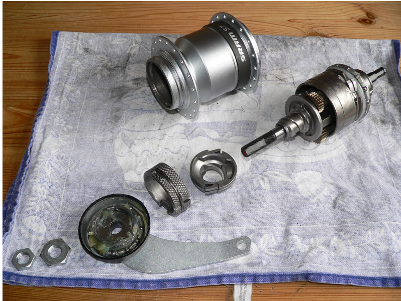
Rücktritt- bremse fußbetätigt
